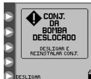
Figura 31. Ecrã de Erro de deslocação do conjunto de bomba
