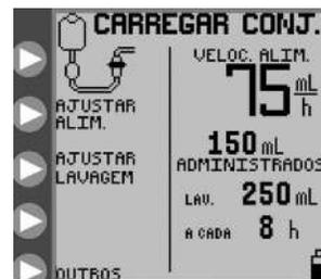
Figura 5A. **CARREGAR UM CONJUNTO** ecrã de menu de abertura para o modo de alimentação contínua (Modo de Bomba EZ não ativado).
