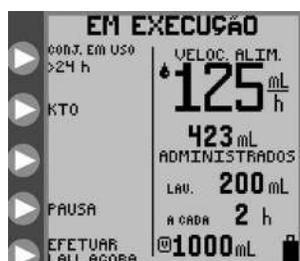
Figura 34. Ecrã de funcionamento com o indicador de utilização de definição de bomba > 24 HRS no canto superior esquerdo do ecrã.
